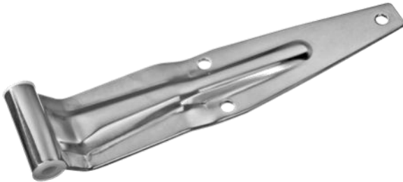
L21286/ZP - 12 micron verzinkt L21286/SS - rvs/304 Scharnierblad, materiaaldikte 4 mm. Met nylon lagering
