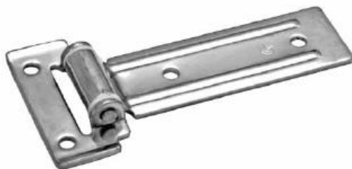
7718ZP - 12 micron verzinkt 7718SS - rvs/304 Scharnierblad, materiaaldikte 3 mm.
